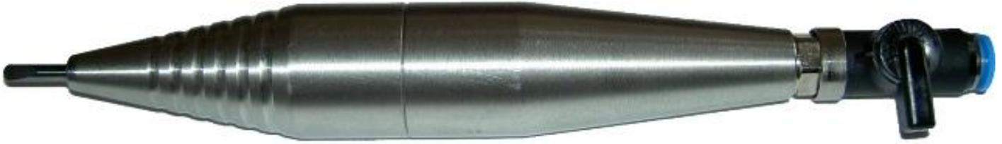
Modell HW 25 eignet sich für gröbere Präparationen, vor allem lassen sich bei diesem Gerät **sehr lange Meissel** einsetzen.
